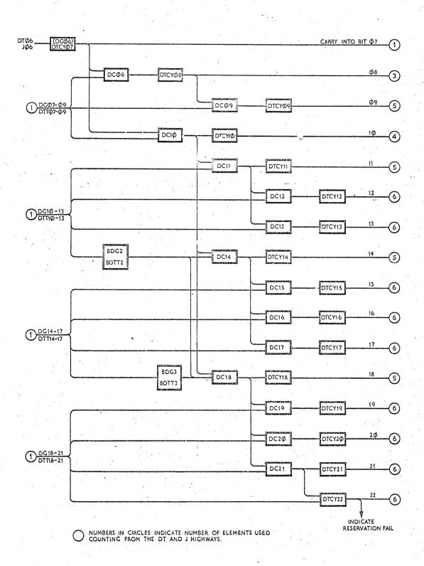
FIG. 2-4 DATUM ADDER BLOCK CARRY SYSTEM.
